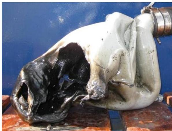
Abbildung 5: Wassersammler (ausgebaut) mit Brand- und Hitzeschaden
