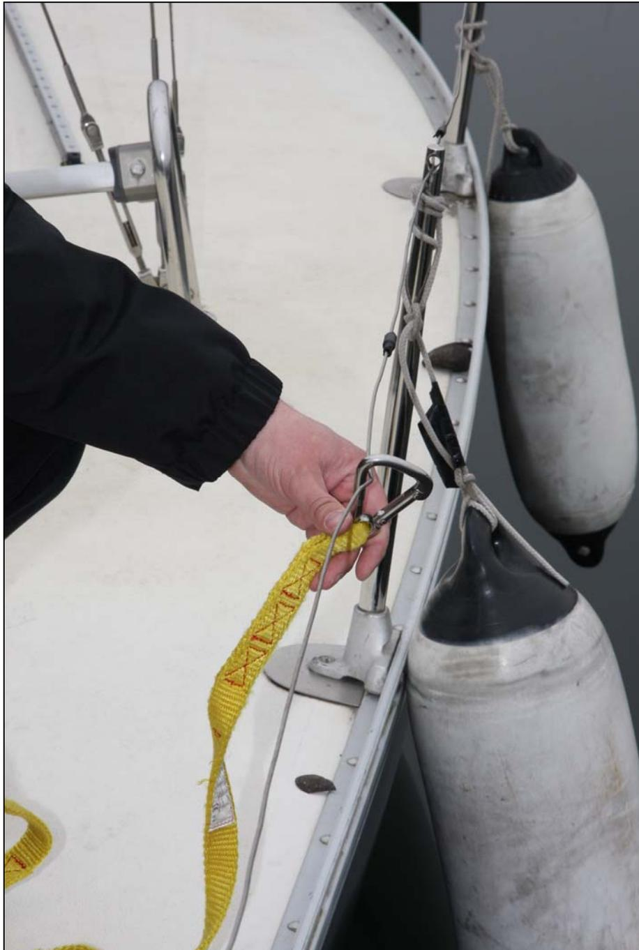
Abbildung 5: Entstehung des Knicks im Draht der Reling
