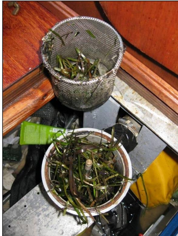
Abbildung 4: zugesetztes Seewasserfilter der Motorkühlung
