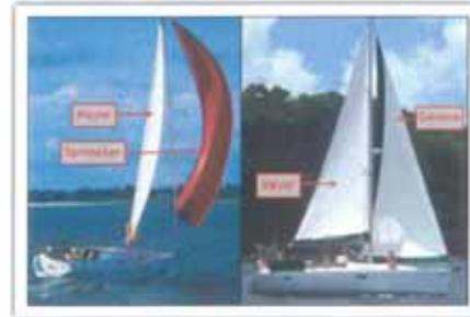
Abbildung 4: Segel des Segelschiffs
