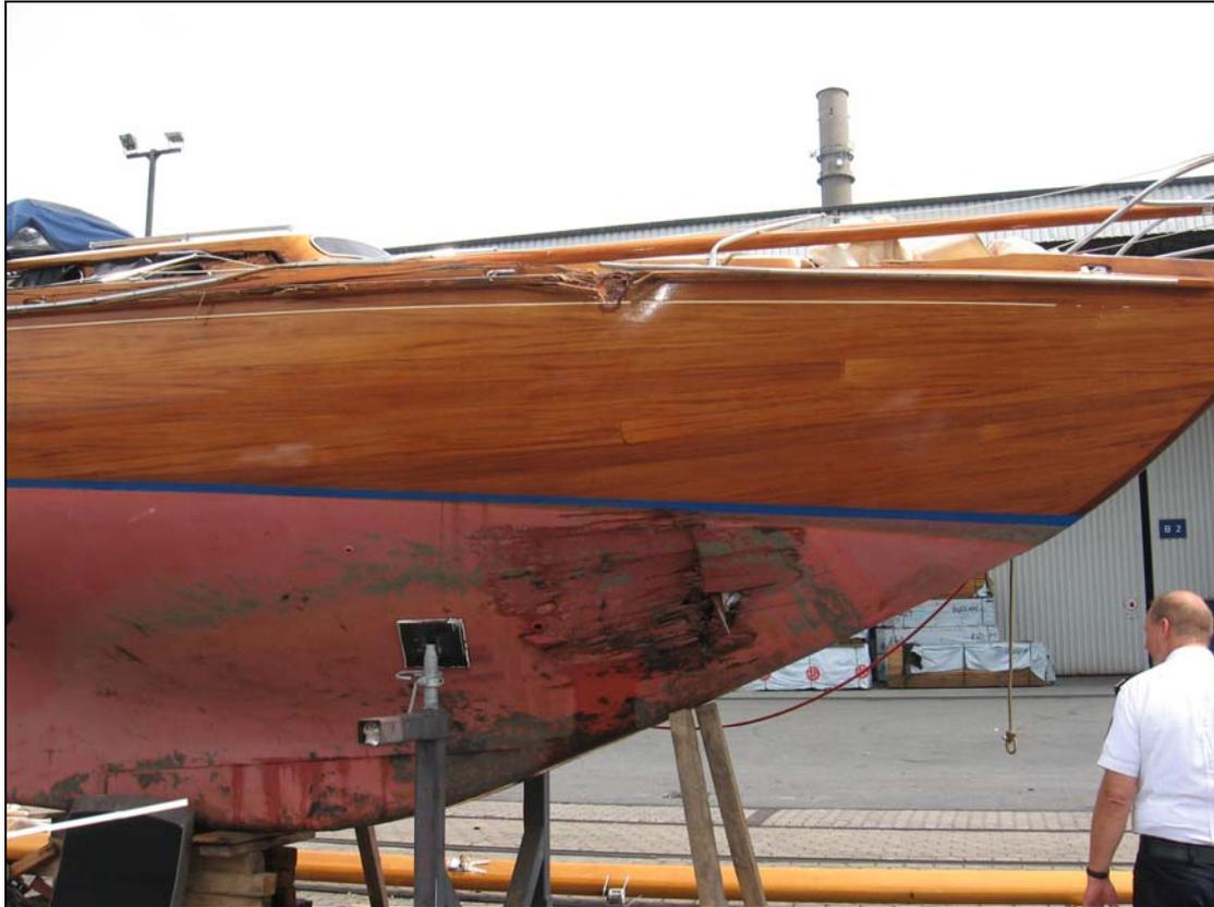
Abbildung 4: Eingedrückte Planken der RØDE ORM im Unterwasserbereich
