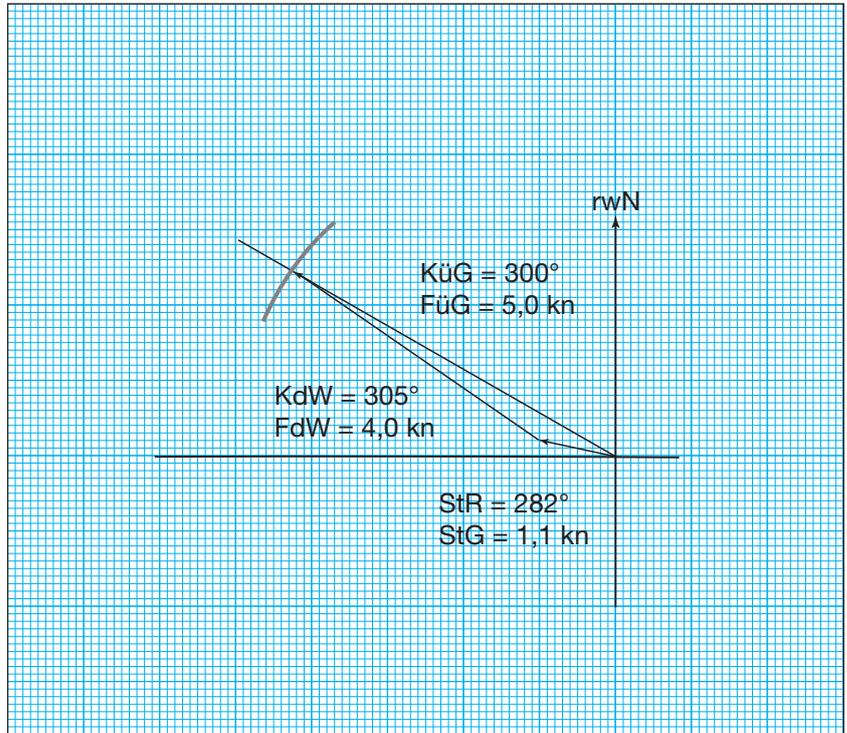
Die Bordinstrumente zeigen eine andere Fahrt über Grund an. Daher koppelt man vom WPT 1, dem beobachteten Ort ( $O_b$ ) um 11:00 BZ mit  $FüG = 4,5$  kn.
