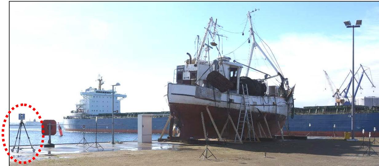
**Abbildung 10: 3-D-Laserscanning FK CONDOR durch LKA Hamburg (15.03.2016)**
