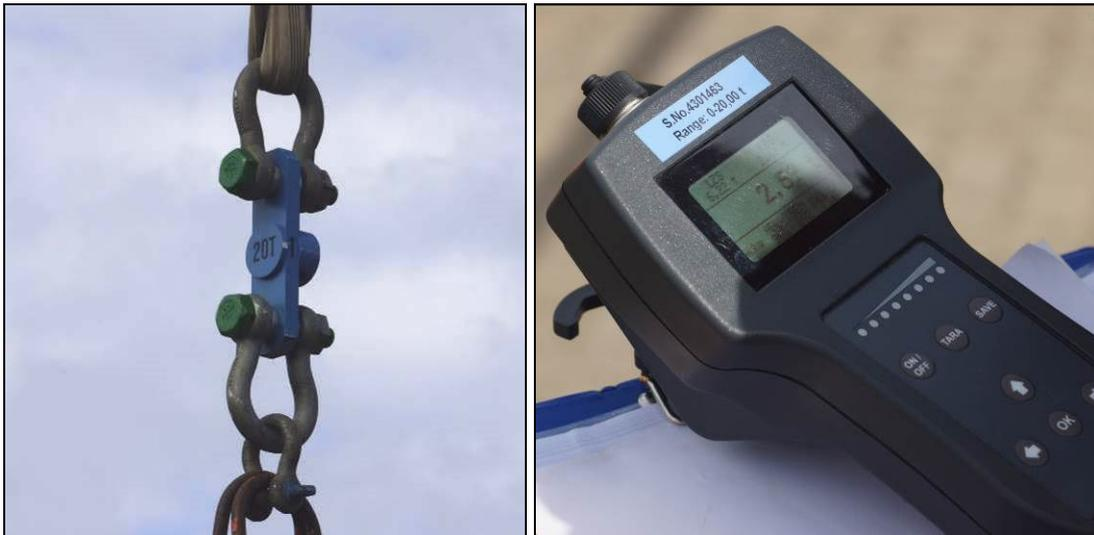
**Abbildung 12: Spezialwaage und Gerät zur drahtlosen Erfassung der Messergebnisse**
