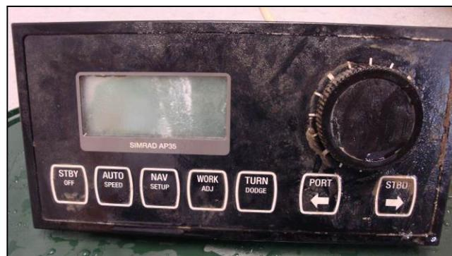
**Abbildung 56: Autopilotsteuerung Typ AP35**
