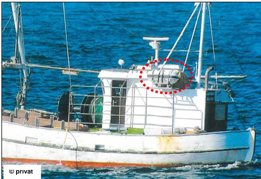
**Abbildung 33: Position des Rettungsfloßes an Bord des FK CONDOR**
