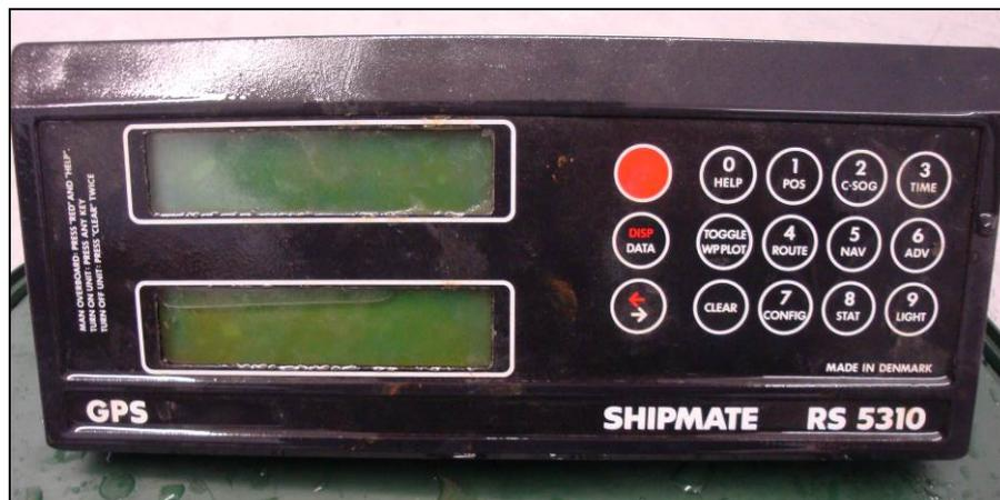
**Abbildung 57: GPS-Empfänger Typ RS 5310**
