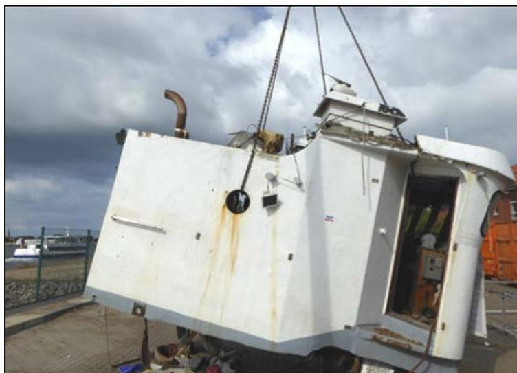
**Abbildung 118: Verwiegung der kompletten Aufbauten inklusive Toilettenraum und Auspuff**
