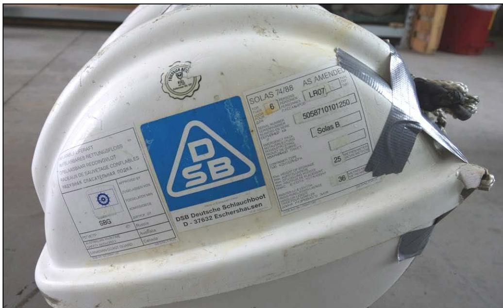
Abbildung 43: Informationen über Typzulassung, Hersteller und technische Angaben auf dem Floß-Container
