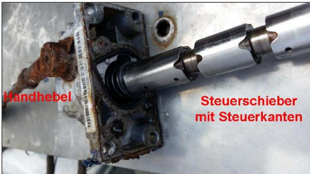
**Abbildung 100: Spiegel des 4/3-Wege-Ventils für die Kurrleinenwinde**
