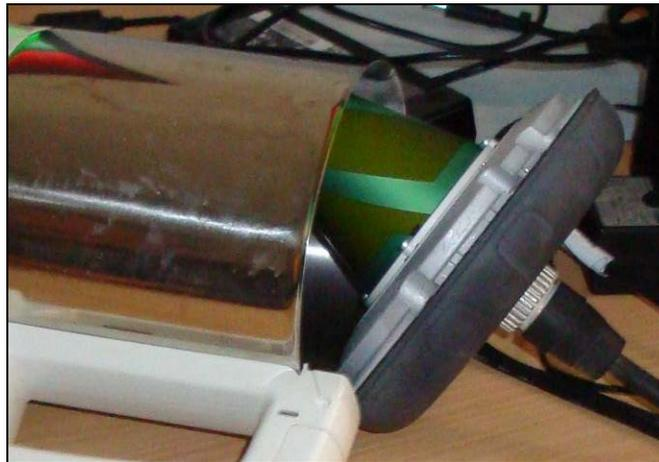
**Abbildung 66: Abschirmung der Antenne mittels eines Metallbehälters**
