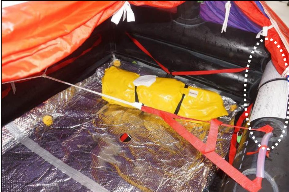
Abbildung 53: Hinweise auf Seriennummer / Hersteller / durchgeführte Wartungen
