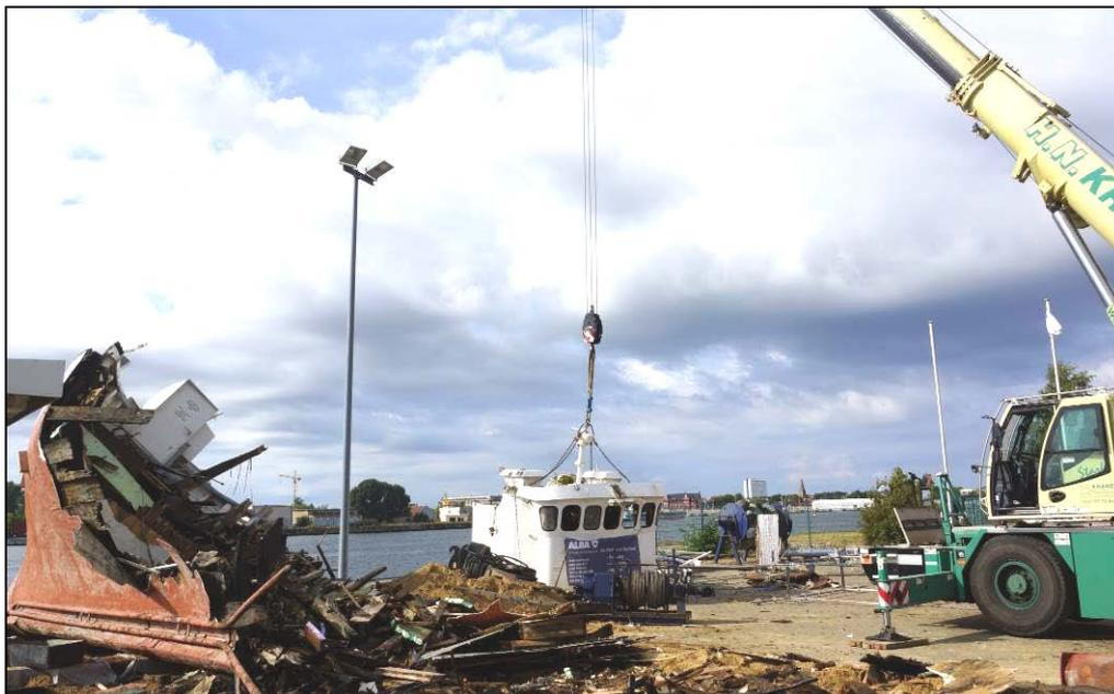
**Abbildung 11: Bestimmung einzelner Massen anlässlich des Abwrackens des Kutters (hier des Brückenhauses) im September 2016**
