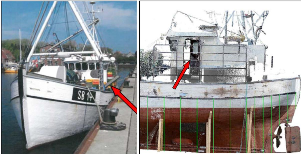
**Abbildung 124: Stauplatz für leere Fischkisten Backbordseite Aufbauten**
