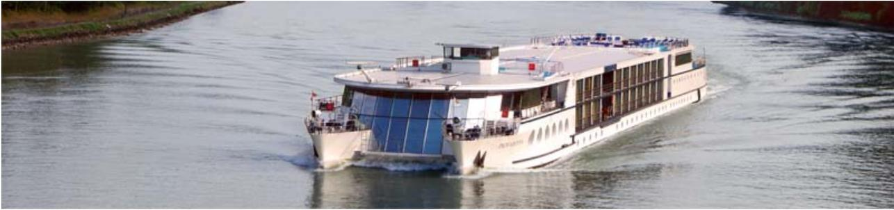
Abbildung 2: „PRIMADONNA“ mit ausgefahrenem Steuerhaus (Quelle Gewerbliches Unternehmen)
